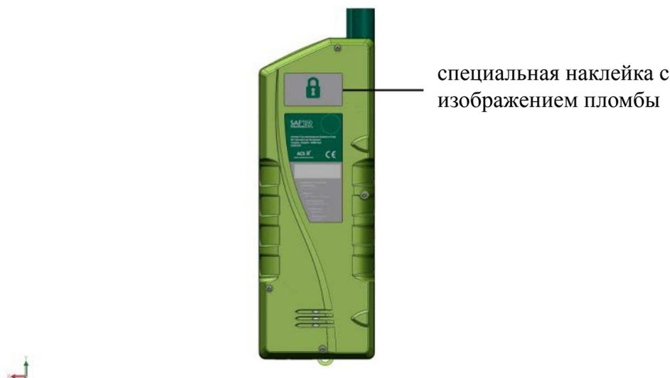
Рисунок 2 – Вид оборотной стороны анализатора со специальной наклейкой с изображением пломбы.
