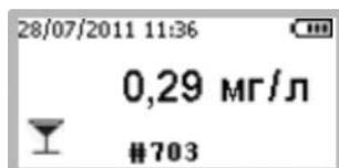
Затем на дисплей выводится результат измерения массовой концентрации этанола в отобранной пробе выдыхаемого воздуха в виде «X.XX» в мг/л.
