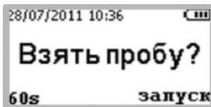
Для выполнения пассивного измерения держите в руке анализатор, направляя его проботборное отверстие, расположенное с левой стороны анализатора, ко рту обследуемого (мундштук не требуется). Попросите обследуемого выполнить выдох и нажмите на кнопку Пуск (выберите Запуск).
